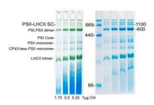
BN-PAGE 3-12% Precast Gel 样品: 豌豆类囊体膜蛋白 恒压 120V 1.5 h 1×BN/CN 电泳缓 冲液 冰浴电泳 BN-PAGE 4-16% Precast Gel 样品: 豌豆类囊体膜蛋白 恒压 120V 2 h 1×BN/CN 电泳缓冲液 冰浴电泳
